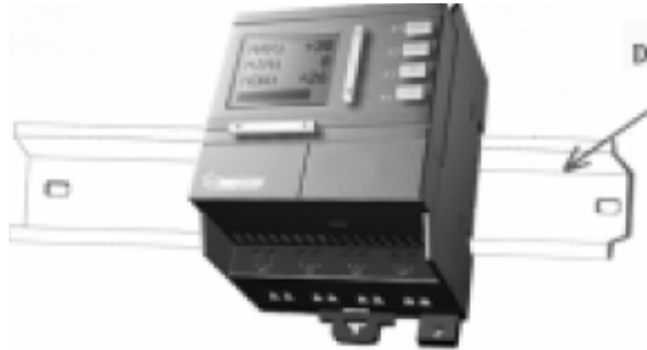
Рис. 2.1 Установка контроллера SR на стандартную DIN-рейку.
