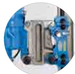
Вставка ModulDrill для сверления до Ø 500 мм
