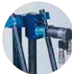
Эффективное управление сверлением с помощью гидравлической подачи каретки
