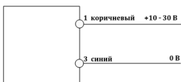
Схема подключения излучателя (все модели)
