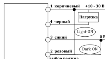
Схема №2 для подключения моделей с выходом NPN
